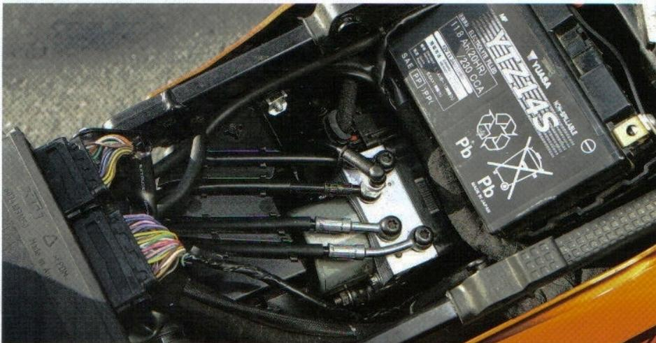
Das in der KTM verbaute Bosch-ABS 9M enhanced mit elektronischer Verbundbremse ist die Basis für die MSC-Stabilitätskontrolle.
