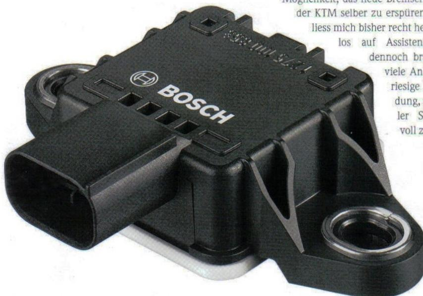
Der Bosch-Schräglagensensor wiegt nur 40 g und erfasst Längs-, Quer- und Vertikalbeschleunigung, Gier- und Rollrate und errechnet daraus die Schräglagen- und Nickwinkel.
